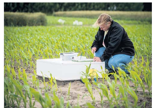
Ved små stationer som denne bliver udslippet af drivhusgasser (lattergas) målt på de forskellige parceller. Foto: Johan Gadegaard
